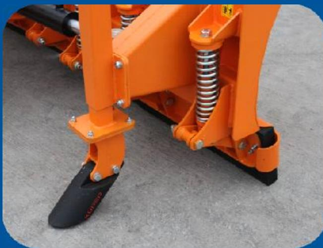
Küper - Gleitkufe ist höchstfest und wurde aus der Mischung von Stahl, Gummi und Korund gefertigt. Im Vergleich zu normalen Gleitkufen aus Stahl zeichnen sie die Küper - Gleitkufen durch eine viel längere Lebensdauer (bis 300% höhere Verschleißfestigkeit) aus.
