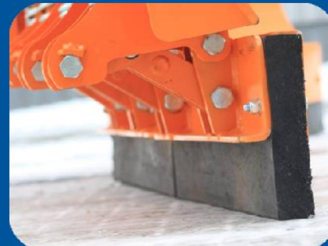
Die Gummileiste bleibt elastisch und robust bei niedrigen Temperaturen, sie ist stoßunempfindlich und der Schnee klebt an der Gummileiste nicht. Die Gummileiste ist vierteilig, die Teile arbeiten unabhängig voneinander, was die Spannungen begrenzt.
