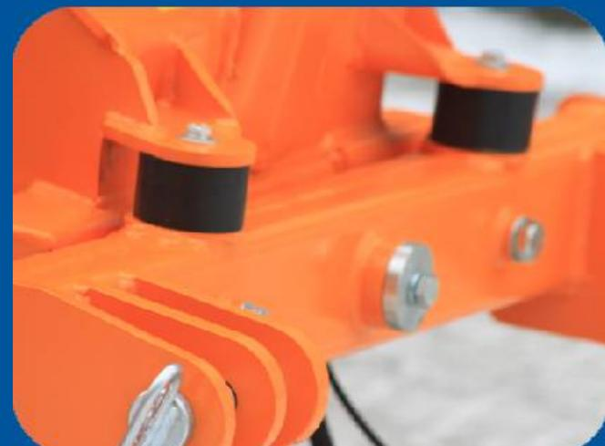
Das Bodenanpassungssystem bestehend aus schwenkender Aufhängung mit Gummidämpfer ermöglicht die Anpassung der Schar an die Struktur des Geländes.
