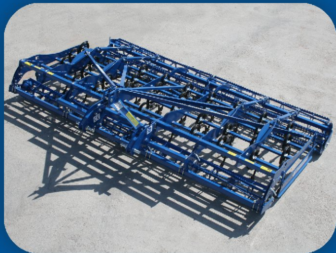
Saatbettkombinationen in starrer Version sind in Arbeitsbreiten 3,0m, 3,5m und 4,0m verfügbar.
