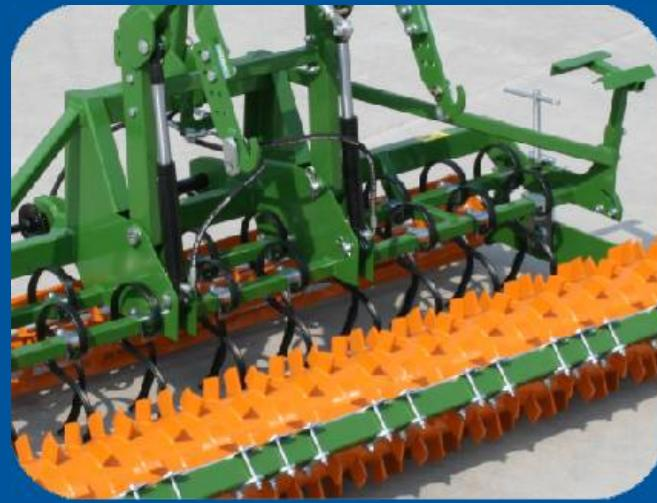
Saatbettkombination mit Aushebung für Drillmaschine ist eine gute Lösung für landwirtschaftliche Betriebe, die über Schlepper mit geringer Hubkraft verfügen. Für die Wahl der leichten Saatbettkombination sprechen minimale Unterhaltungskosten.
