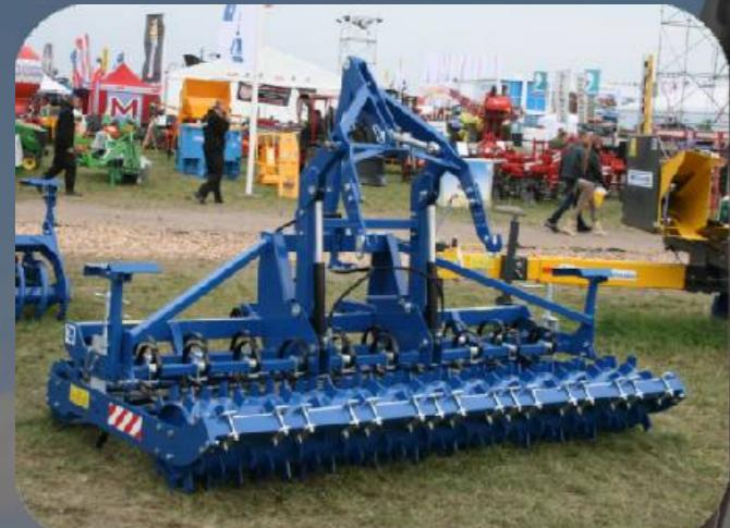
Die von Kunden meist gewählte Heckwalze für Saatbettkombination ist Rohrwalze für leichte Böden, für schwerere Böden Krümlerwalze mit Zahnleisten oder Zahnwalze Packer, und für den scholligen Boden eine gut bodenkrümelnde Crosskill-Walze.
