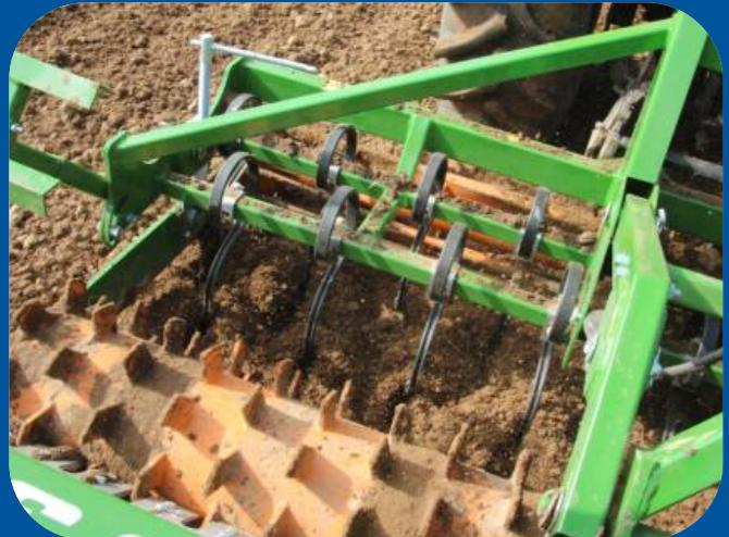
S-Zinken werden in 2 oder 3 Reihen angeordnet und optimieren den Durchgang von Pflanzenrückständen, Bodenschollen und Steinen. Arbeitskomponenten werden an leichte und mittlere Böden angepasst und ermöglichen die Arbeit mit der Geschwindigkeit von sogar 12km/h.
