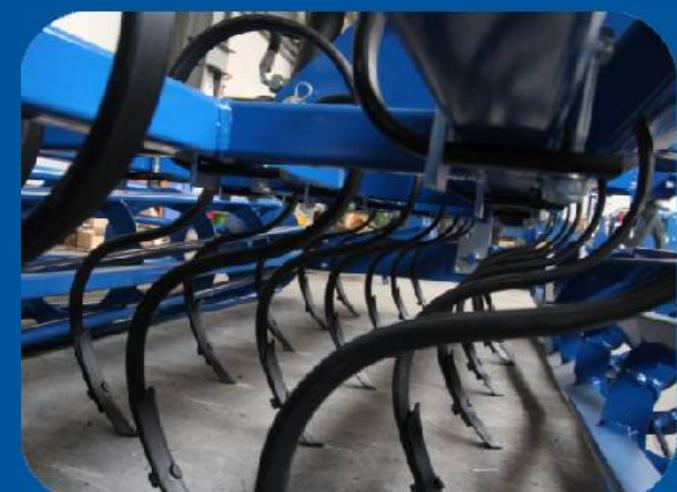
S-Federzinken können am Maschinenrahmen, auf zwei oder drei Balken montiert werden. Auf dem Foto das Gerät in der Version mit drei Zinkenreihen.
