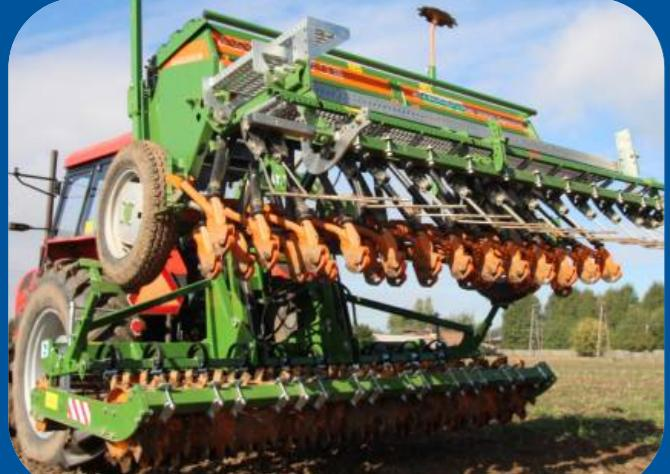
**Die Konstruktion der Saatbettkombination mit der Anbaukupplung für Drillmaschine lässt den Schwerpunkt sehr nah am Schlepper verschieben. Saatbettkombination besteht aus einer passiven Rolmako - Saatbettkombination und Amazone Drillmaschine.**
