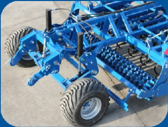
Anbaukupplung für Drillmaschine oder für Cambridge-Walze ist als eine Option für gezogene Maschinen mit starrem und hydraulisch klappbarem Rahmen erhältlich.
