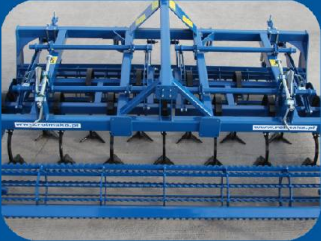
Zinken SU wird aus einer Feder 32x12mm gefertigt und ist standardmäßig mit zusätzlicher Verstärkung ausgestattet. Für verdichtete oder sumpfige Böden empfehlen wir gekrümmte Zinken SU oder gerade Zinken SA statt Gänsefußschar.
