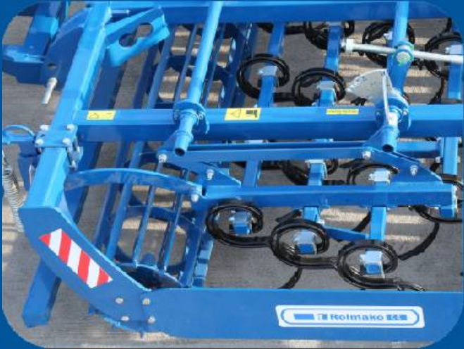
Zinken SU wird aus einer Feder 32x12mm gefertigt und ist standardmäßig mit zusätzlicher Verstärkung ausgestattet. Für verdichtete oder sumpfige Böden empfehlen wir gekrümmte Zinken SU oder gerade Zinken SA statt Gänsefußschar.
