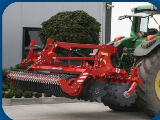
Scheibenegge 3,0 m in der aufgehängten Version. Die Landmaschine ist mit Gummiwalze sowie Anbaukupplung für Drillmaschine ausgestattet. In dieser Kombination wiegt das Aggregat 1900kg.
