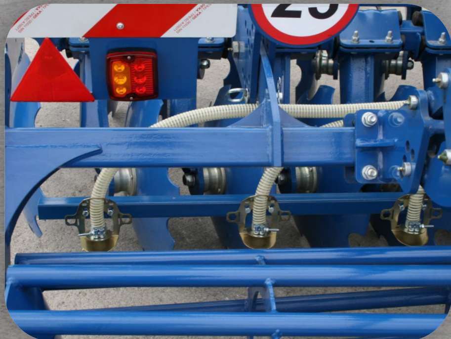
Das Saatgut wird vor der Packerwalze ausgesät und ein zusätzlicher Balken vor der Packerwalze installiert
