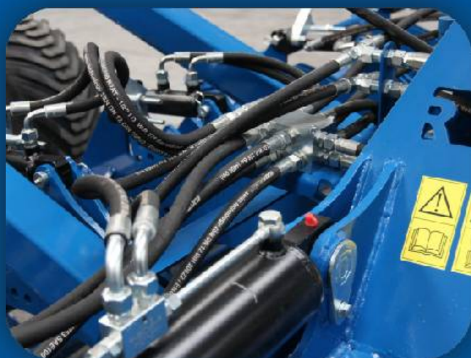
Die meisten Funktionen von den Scheibeneggen basieren auf hydraulischen Systemen.
