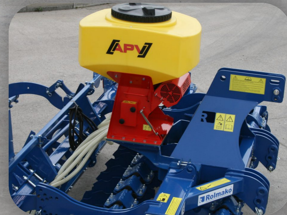
Die Montage an Scheibeneggen U 693 erfolgt mit Hilfe von speziell konstruierten Konsolen
