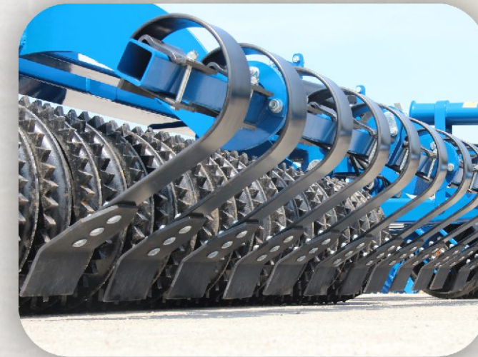
Verstärkte Crossboard-Schleppe 80x10mm, Gleitkufen 150mm breit
